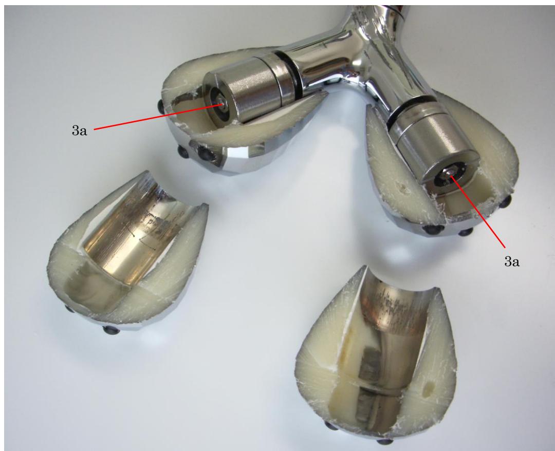
ローリング部を切断したときの断面写真 2
