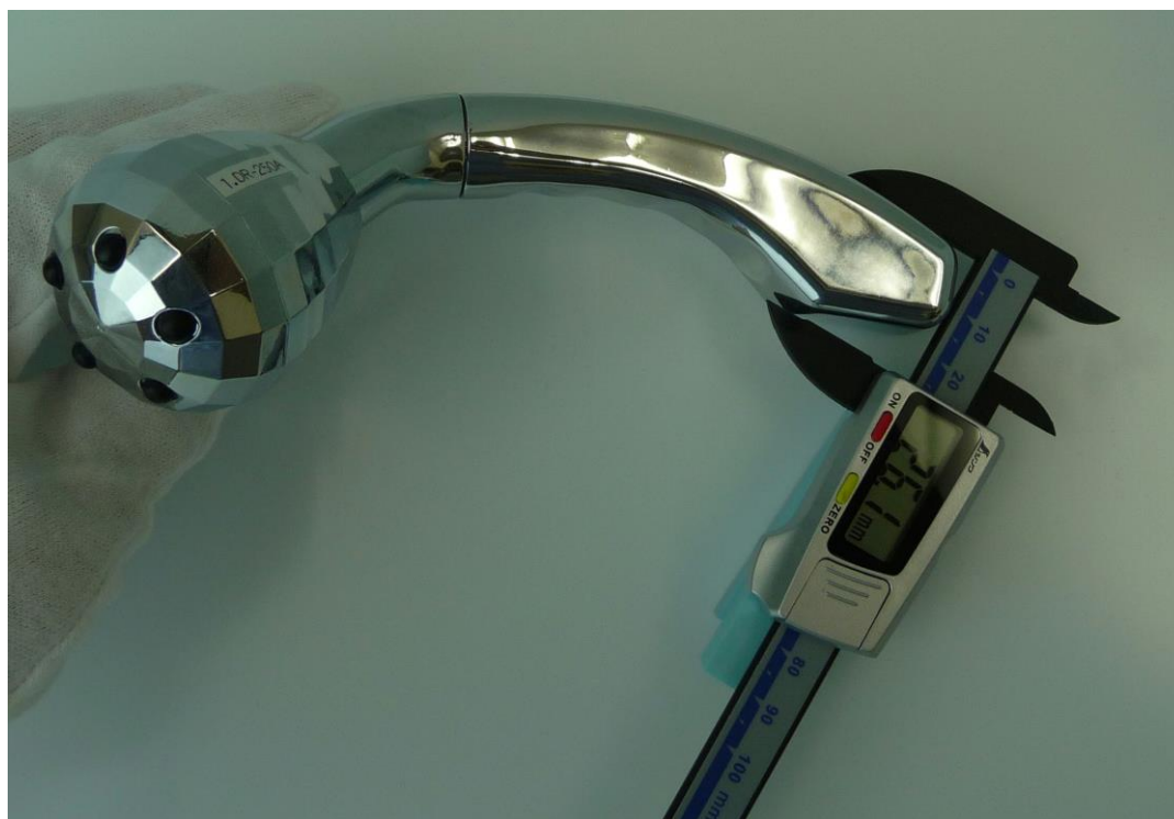
訴状別紙【b】に対応する部分の厚みの測定結果（測定器具同上）
