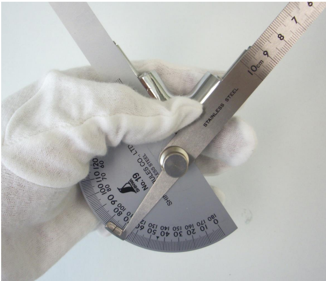
角度測定写真（測定器具：シンワ測定株式会社プロトラクターNo.19）
