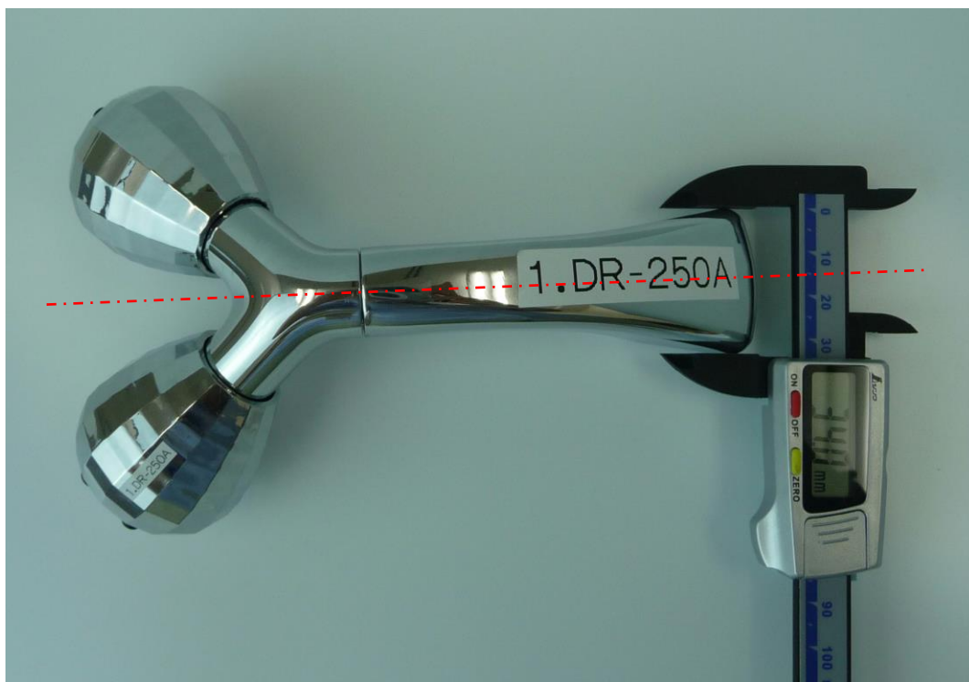
ハンドルの最も厚い部分の測定結果 (測定器具：シンワ測定株式会社デジタルノギス品番 19978)
