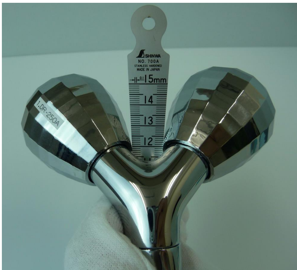
一対のローリング部の最短の間隔の測定結果 (測定器具：シンワ測定株式会社テーパージージ No.700A)
